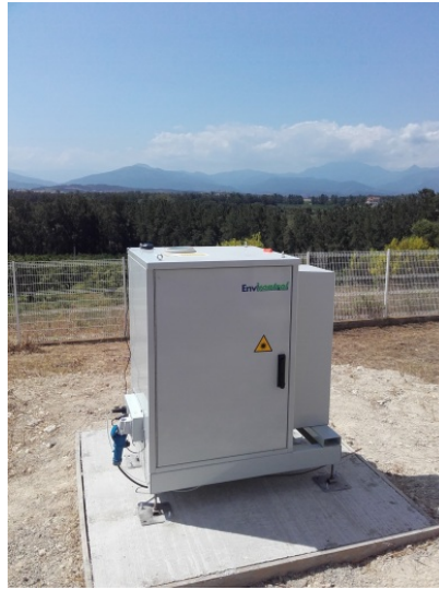
Figure 1. Typical Mini Micro Pulse LiDAR (MiniMPL) unit from Météo-France the Météo-France network.
